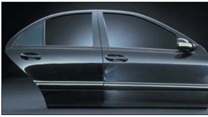
Türen einer Mercedes C-Klasse mit \text{SiO}_2 -Nanopartikeln nach 88 Autowäschen. Links mit Nanopartikeln, rechts ohne
