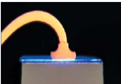
LED-Chip von der Seite betrachtet. Der Golddraht kontaktiert die licht- emittierende Fläche.
