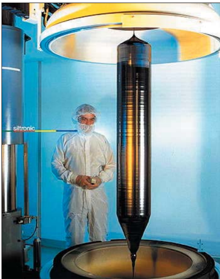
Ein Siliziumkristall. Aus ihm werden einzelne Scheiben, die Wafer, geschnitten.
